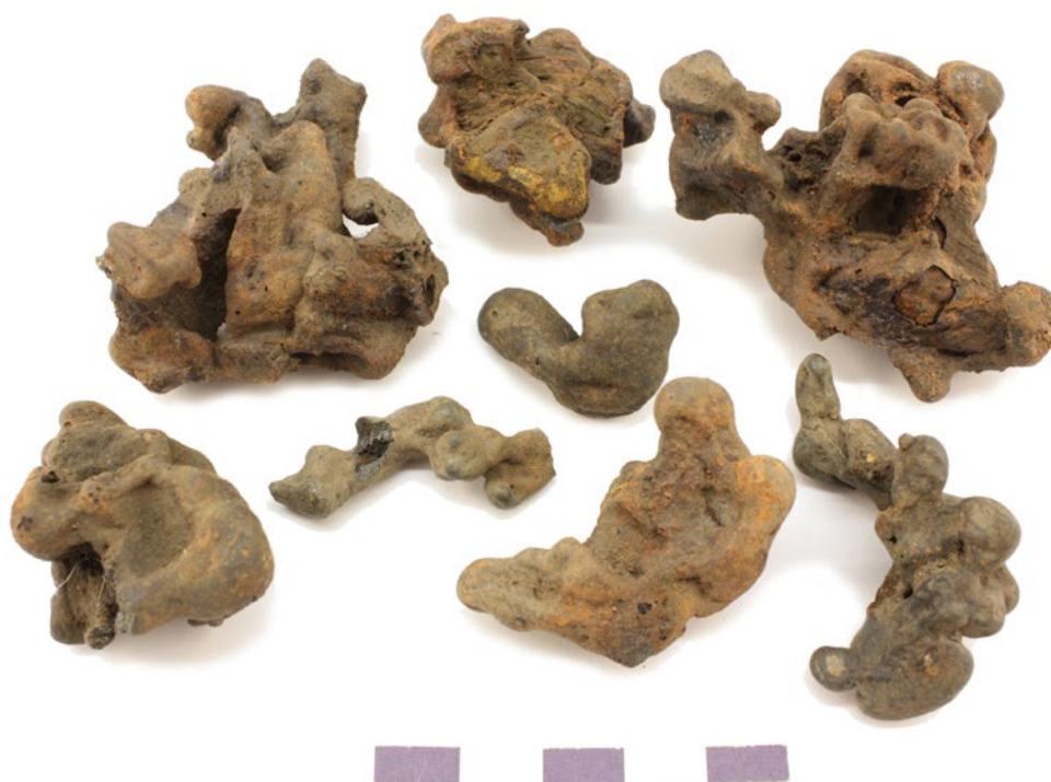
Figur 35. Ett urval av typiska stearinformede slagger från ugnsanläggningen. Bild hämtad ur analysrapporten, bilaga 8, s.18 (fig. 14).
