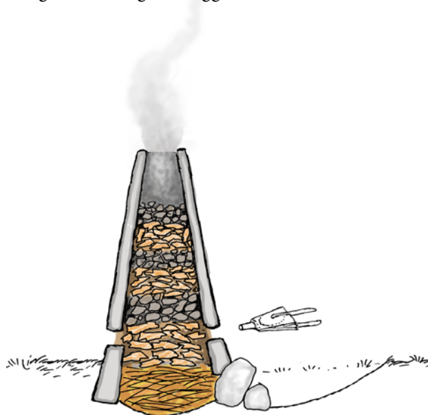
Figur 41. Exempel på hur en blästugn från järnåldern kunnat se ut. Ovanför stenramen och den leruppbbyggda sockeln syns två blästeringångar. Till höger syns en arbetsgrop där ugnen kunnat rakas ur efter användning. Illustration: Anders Andersson.
