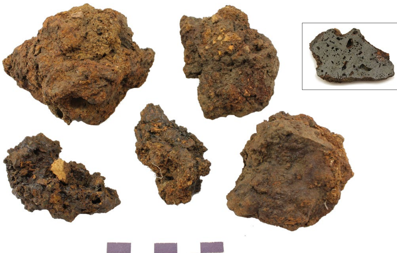
Figur 36. Ett urval av trögflutna, tyngre slagger. Den infällda bilden visar en av bitarna i delat tvärsnitt, med homogen sammansättning. Bild hämtad ur analysrapporten, bilaga 8, s.20 (fig. 17). Skala 1:1.
