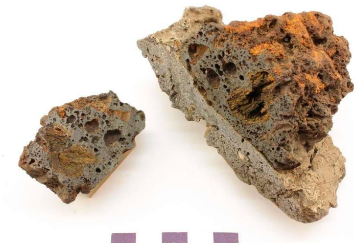
Fig. 18. Tvärsnitt av växtmagrad slaggropsfodring med fastsmält kompakt slagg (se fig. 1 och 3). I den homogena slaggen (biten till vänster är analyserad) ses också ett inkapslat träkolsstykke.
