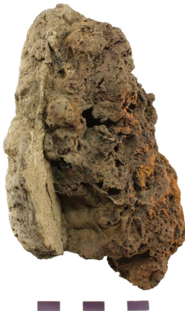
Figur 32. Växtmagrad slaggropsfodring med formad insida (tv) med fastsmält, kompakt slagg (th). Bild hämtad ur analysrapporten, bilaga 8, s.9 (fig. 1). Skala 1:1.
