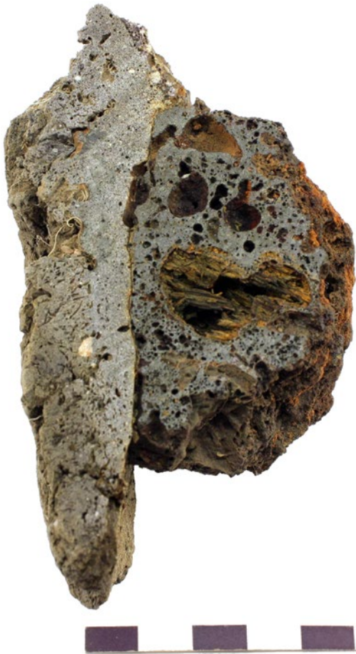
Figur 33. Ett tvärsnitt av fragmentet som visas i figur 32. Den inre delen av fragmentet, där slagg fastnat, har utsatts för höga temperaturer och därmed sintrat. Bild hämtad ur analysrapporten, bilaga 8, s.10 (fig. 3). Skala 1:1.
