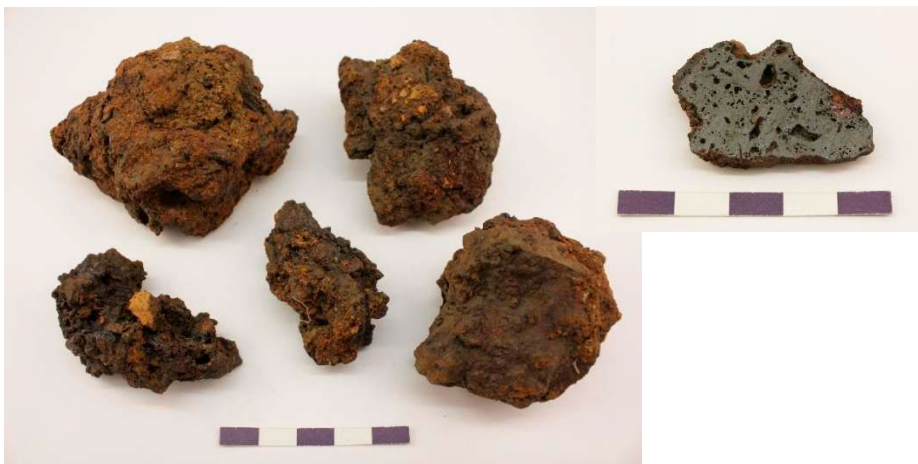
Fig. 17. Ett urval av trögflutna, tyngre slagger. Den infällda bilden visar en av dem i delat tvärsnitt, med homogen sammansättning.
