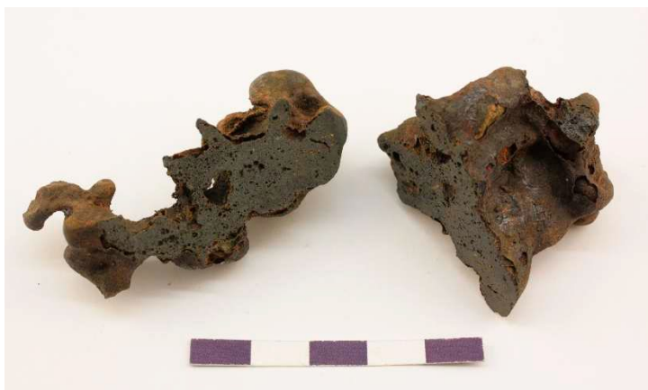
Fig. 16. En av de stearinformade slaggerna (övre högra i figur 14) i delat tvärsnitt. I detta framträder en småporig slagg med homogen sammansättning. Denna slagg har analyserats.
