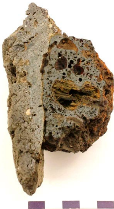
Fig. 3. Tvärsnitt av växtmagrad slaggropsfodring (se fig. 1) med formad insida och fastsmält kompakt slagg som visar värmegradienten på fodringen från en sintrad zon vid kontakten med slaggen till en lägre, reducerad, bränd zon på utsidan.
