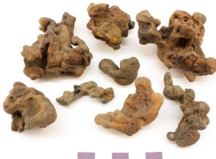
Fig. 14. Ett urval av typiska stearinformade slagger, alltifrån enstaka tunnare strängar (centralt) till större slagger med flera pålagrade slaggsträngar. Biten i övre högra hörnet har också flera kolavtryck. Den ses i delat tvärsnitt i fig. 16.
