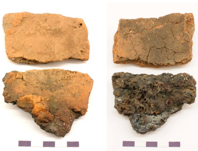
Fig. 10. Utsida (Tv) och insida (Th) på schaktfragment från figur 8 (nedre) jämfört med ett fragment som sannolikt hört till den övre delen av schaktet (ovan). Det senare är enbart hårt bränd och krackelerat på insidan men har inte nått sintringstemperaturer. Enbart små rester av det yttre växtmagrade lagret är bevarade.
